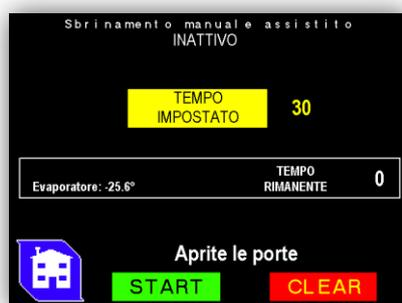
Dopo aver messo la macchina in OFF e svuotato la cella dai prodotti. Aprite almeno una porta. Fate partire il programma pigiando il tasto START. Verrà visualizzata la temperatura dell'evaporatore e il tempo restante al termine. In ogni caso se decidete di interrompere l'operazione sarà sufficiente pigiare il tasto CLEAR. Durante l'operazione è possibile visualizzare altri menù.
