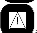
Stop macchina causato da un allarme importante (solo per le versioni con compressore dedicato)
