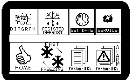
Nel menù SETUP: Sulla sinistra, pigliando l'icona **DIAGRAM** potrete accedere allo schema elettrico di collegamento al PLC. Sarà molto utile se dovrete cambiare una sonda guasta ad esempio. Lo schema è diviso su due livelli, uno superiore ed uno inferiore. A destra l'icona **ASSISTED DEFROST** vi farà accedere alla pagina dello sbrinamento assistito (vedi a pag. 12). Più a destra **SET DATE** l'impostazione della data e dell'ora. **SERVICE** è un menù accessibile solo dal personale tecnico.
