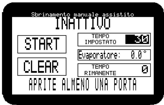
Dopo aver messo la macchina in OFF e svuotato la cella dai prodotti. Aprite almeno una porta. Fate partire il programma pigiando il tasto START. Verrà visualizzata la temperatura dell'evaporatore e il tempo restante al termine. In ogni caso se decidete di interrompere l'operazione sarà sufficiente pigiare il tasto CLEAR. Durante l'operazione è possibile visualizzare altri menù.
