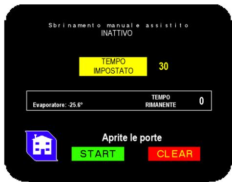
Dopo aver messo la macchina in OFF e svuotato la cella dai prodotti. Aprite almeno una porta. Fate partire il programma pigiando il tasto START. Verrà visualizzata la temperatura dell'evaporatore e il tempo restante al termine. In ogni caso se decidete di interrompere l'operazione sarà sufficiente pigiare il tasto CLEAR. Durante l'operazione è possibile visualizzare altri menù.
