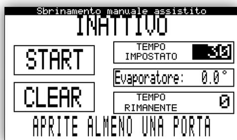
Dopo aver messo la macchina in OFF e svuotato la cella dai prodotti. Aprite almeno una porta. Fate partire il programma pigiando il tasto START. Verrà visualizzata la temperatura dell'evaporatore e il tempo restante al termine. In ogni caso se decidete di interrompere l'operazione sarà sufficiente pigiare il tasto CLEAR. Durante l'operazione è possibile visualizzare altri menù.
