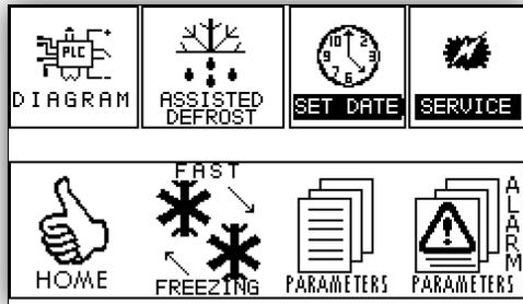
Nel menù SETUP: Sulla sinistra, pigiando l'icona **DIAGRAM** potrete accedere allo schema elettrico di collegamento al PLC. Sarà molto utile se dovrete cambiare una sonda guasta ad esempio. Lo schema è diviso su due livelli, uno superiore ed uno inferiore. A destra l'icona **ASSISTED DEFROST** vi farà accedere alla pagina dello sbrinamento assistito (vedi a pag. 12). Più a destra **SET DATE** l'impostazione della data e dell'ora. **SERVICE** è un menù accessibile solo dal personale tecnico.
